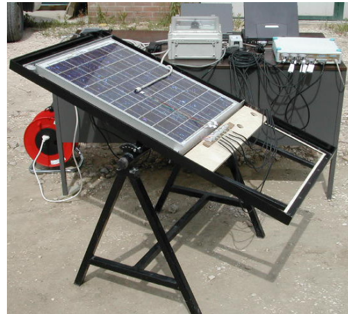
sono stati orientati verso Sud con un'inclinazione di 22,5^\circ rispetto al piano orizzontale (Fig. 2).
