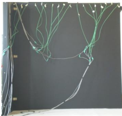
Figura 8: Primo array di 18 termocoppie campionate sulla matrice 18 x 18 – parete posteriore
