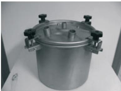
Figura 4. Digestore pilota di tipo batch.
