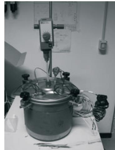
Figura 6. Il digestore equipaggiato con le sonde, il sistema di riscaldamento e di agitazione.
