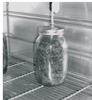
Figura 2. Digestori anaerobici di vetro in camera climatica.
